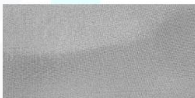
TELA 180 MESH LISA DIÁMETRO 0,05 mm LUZ 0,09 mm AISI 304 L
